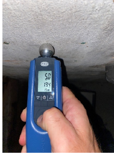
Billede – måling af fugt i ydervægge (baghus)
